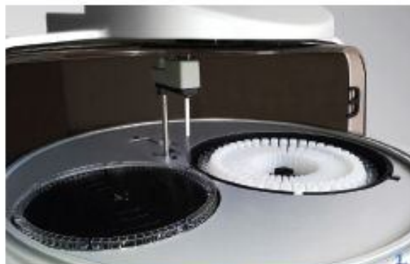
1. Optical carousel and sample/reagent tray Carasello ottico e piatto campioni/reagenti
